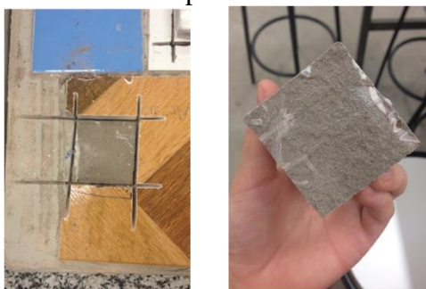
Figura 13 – Amostra 8: AC II, colagem dupla, ruptura B
