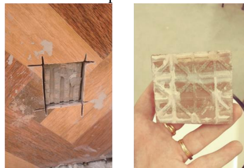
Figura 9 – Amostra 2: AC II, colagem simples, ruptura D
