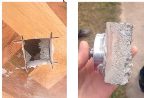
Figura 15 – Amostra 11: AC III, colagem dupla, ruptura C
