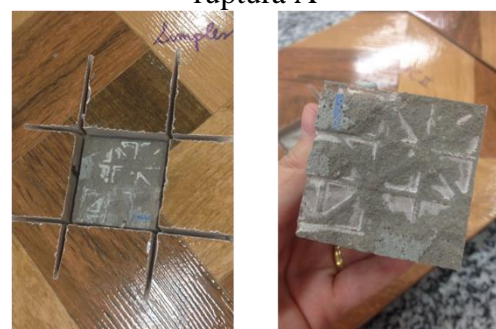
Figura 11 – Amostra 5: AC III, colagem simples, ruptura A
