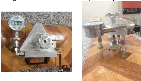
Figura 7 – Aderímetro acoplado à pastilha
