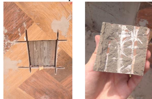
Figura 10 – Amostra 4: AC III, colagem simples, ruptura B
