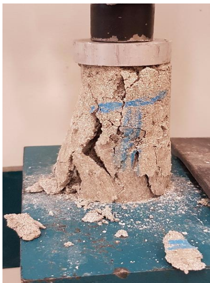
Figura 2 – Corpo de prova esmagado com redução de altura
